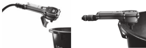
Apparecchio appeso al secchio del miscelatore
