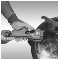
Impostazione del dosaggio in modalità manuale
