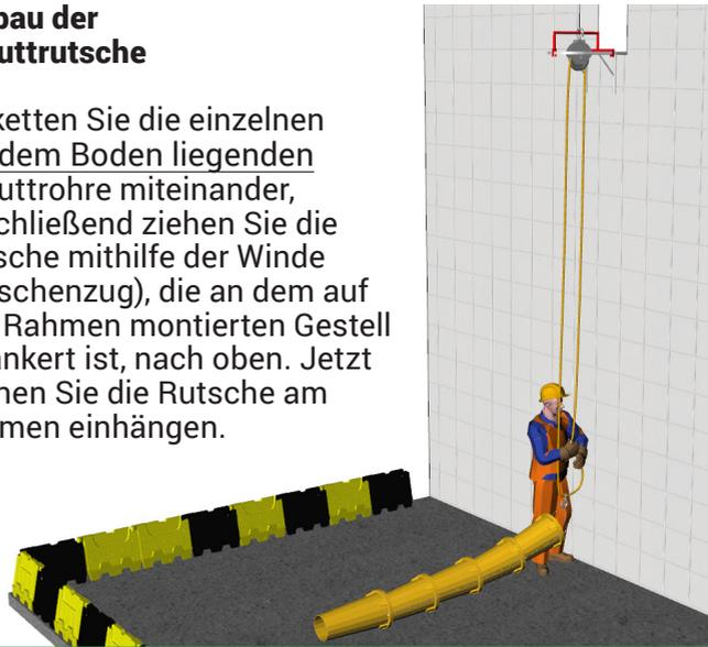
Bei Platzmangel besteht die Möglichkeit die Schuttrutsche in senkrechter Position aufzubauen. Hierzu ziehen Sie das erste Schuttrrohr mithilfe der Winde (Flaschenzug), die an dem auf den Rahmen montierten Gestell verankert ist, etwas hoch. Dann ketten Sie die weiteren Rohre mithilfe der Karabinerhaken nach und nach an. Anschließend hängen Sie die Rutsche am Rahmen ein.
