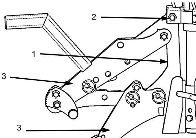
Seitenteile (1) auf Beschädigung und Verformung prüfen. Beschädigte Seitenteile (1) austauschen und verbogene ausbauen und mit Hydraulikpresse ausrichten.
