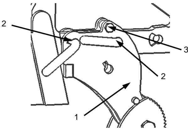
Pratztenhalter (1) und Versteckbolzen (2) auf Beschädigung und Verformung prüfen. Beschädigte oder verbogene Teile austauschen.
